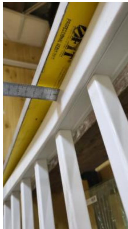
Фото 6. Общий вид после удара по поручню, высота падения 1200мм. Образец не имеет видимых деформаций, небольшая деформация поручня, остекление не выпало. Целостность образца не нарушена.
