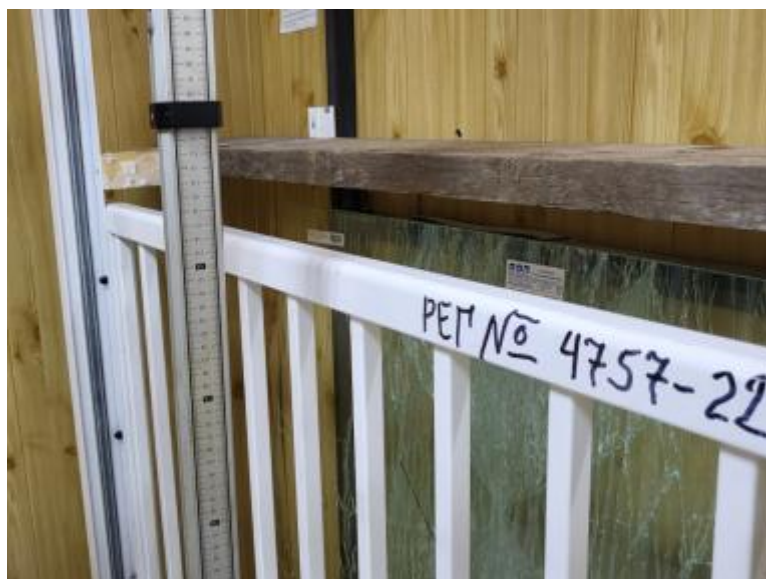
Фото 2. Образец рег. № 4757-22 не имеет видимых деформаций, деформации поручня отсутствуют, остаточная деформация отсутствует.
