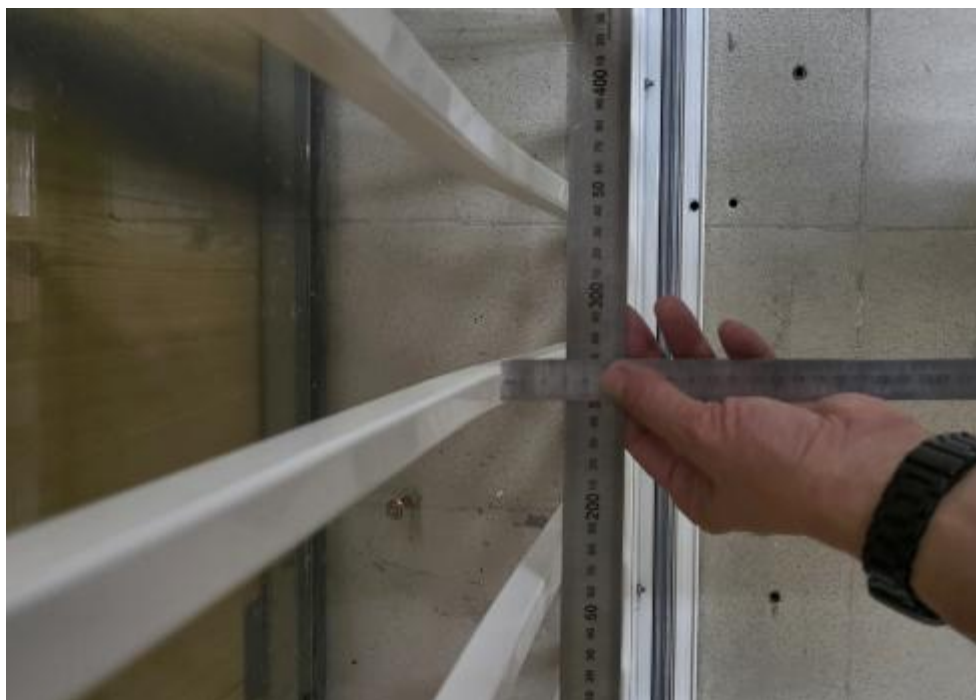
Фото 9. Имеется характерный прогиб вертикальных ограждающих элементов в зоне удара. Целостность образца не нарушена.
