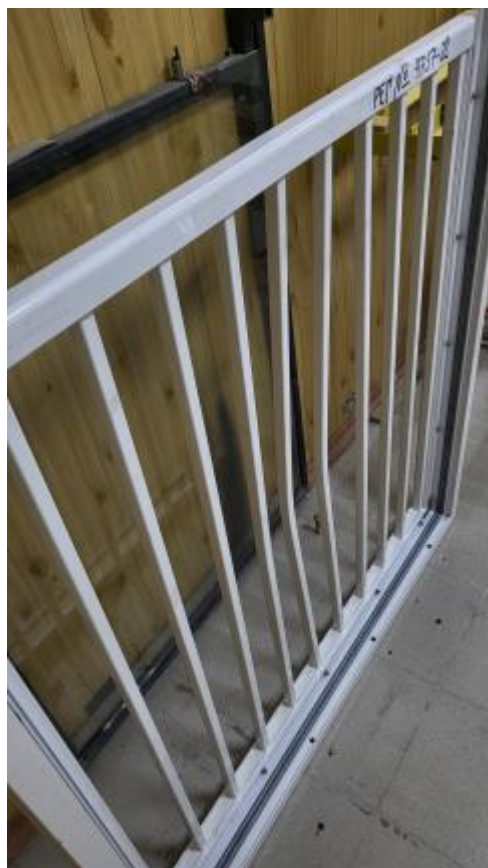
Фото 7, 8. Образец не имеет видимых деформаций, деформации ригеля отсутствуют. Имеется характерный прогиб вертикальных ограждающих элементов в зоне удара. Целостность образца не нарушена.
