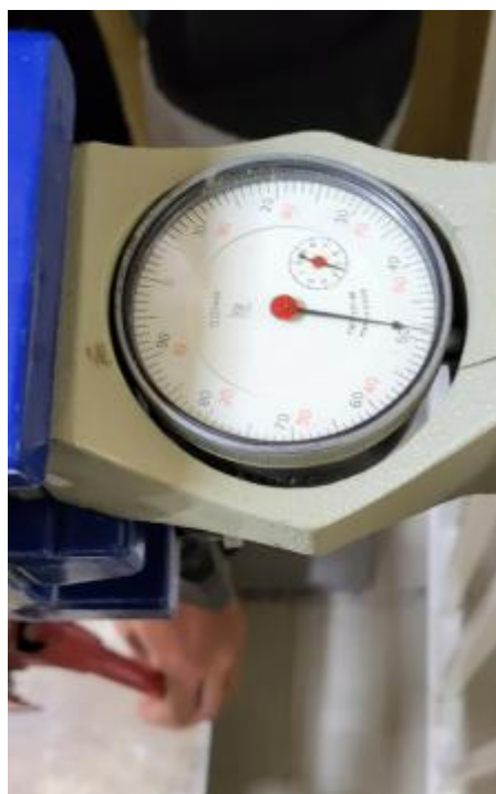
Фото 1. Приложение горизонтальной нагрузки 0,5 кН.
