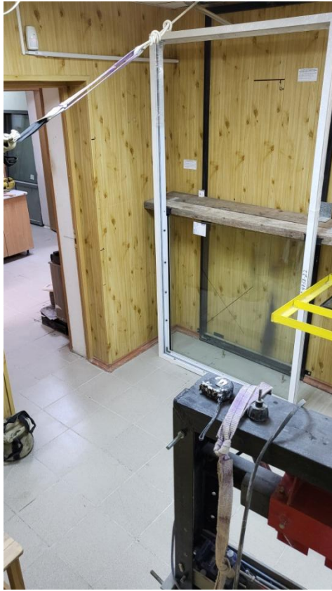
Фото 3. Общий вид стенда перед испытаниями ограждения балконов и лоджий системы TWS 65. Рег. № 4758-22.
