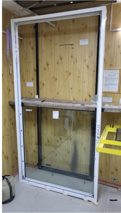
Фото 4. Общий вид после удара по закаленному стеклу, высота падения 1200мм. Образец не имеет видимых деформаций, стекло не разрушилось. Целостность образца не нарушена.
