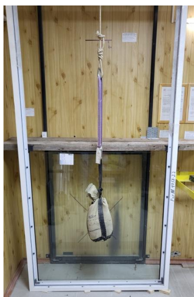
Фото 1. Общий вид стенда для испытаний ограждения балконов и лоджий системы TWS 65 Рег. № 4758-22.
