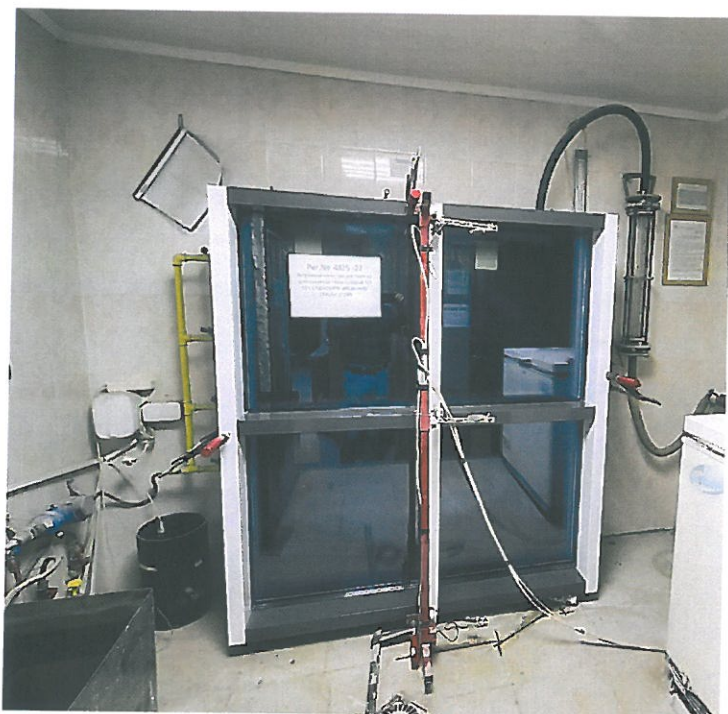
Фото 9. 10. Испытание светопрозрачной конструкции рег. № 4825-22 на сопротивление ветровым нагрузкам
