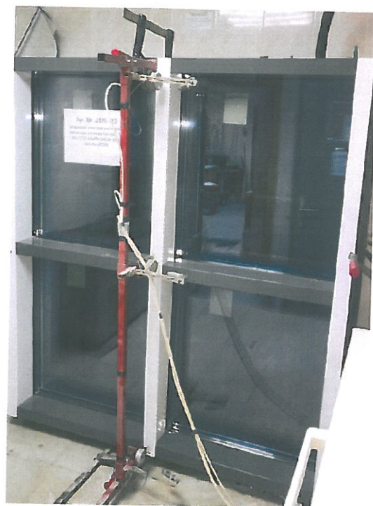
Фото 9. 10. Испытание светопрозрачной конструкции рег. № 4825-22 на сопротивление ветровым нагрузкам
