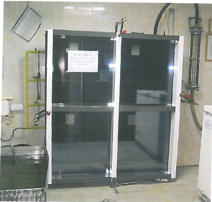
Фото 5. Испытание образца (рег. № 4825-22) на воздухопроницаемость
