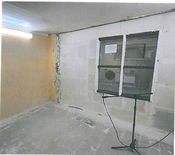
Фото 7. Камера низкого уровня, (испытание светопрозрачной конструкции рег. № 4825-22 в акустической камере)
