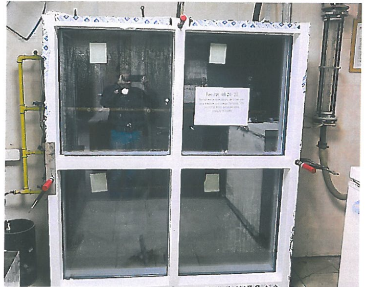
Фото 6. Испытание образца (рег. № 4826-22) на водопроницаемость
