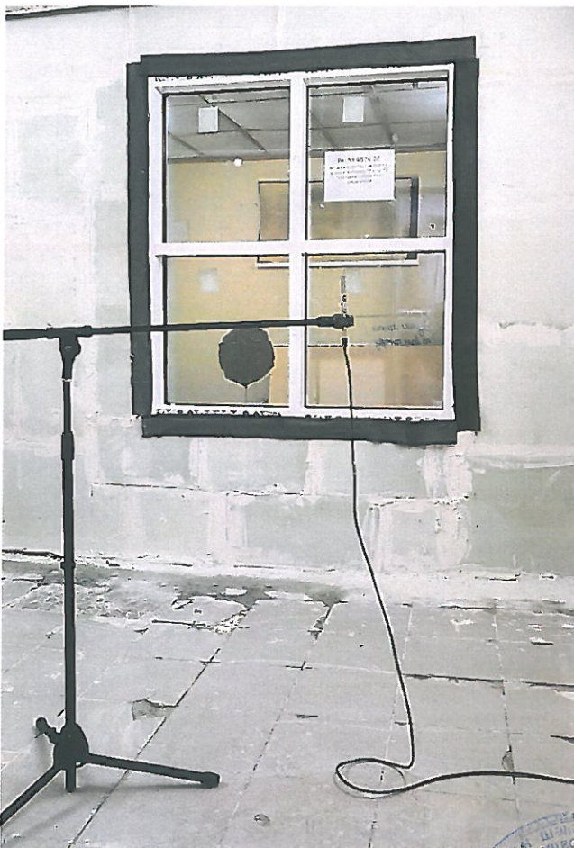
Фото 7. Камера низкого уровня, (испытание светопрозрачной конструкции рег. № 4826-22 в акустической камере)
