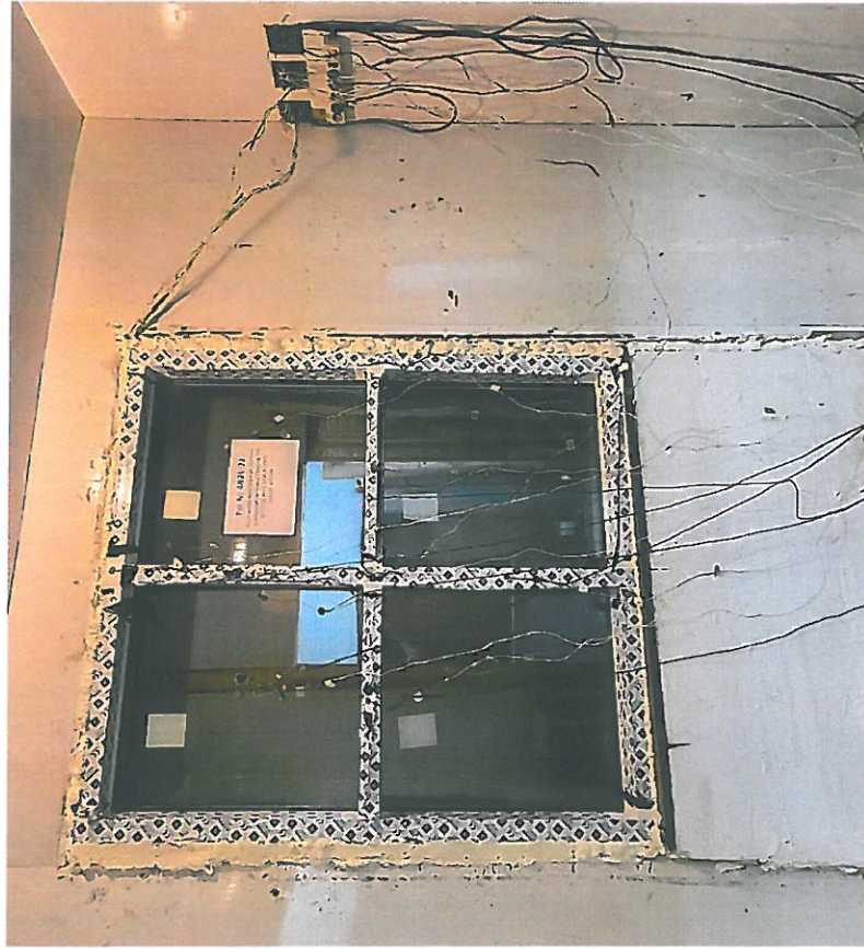
Фото 1. Светопрозрачная конструкция № 4826-22 в климатической камере (теплая сторона)
