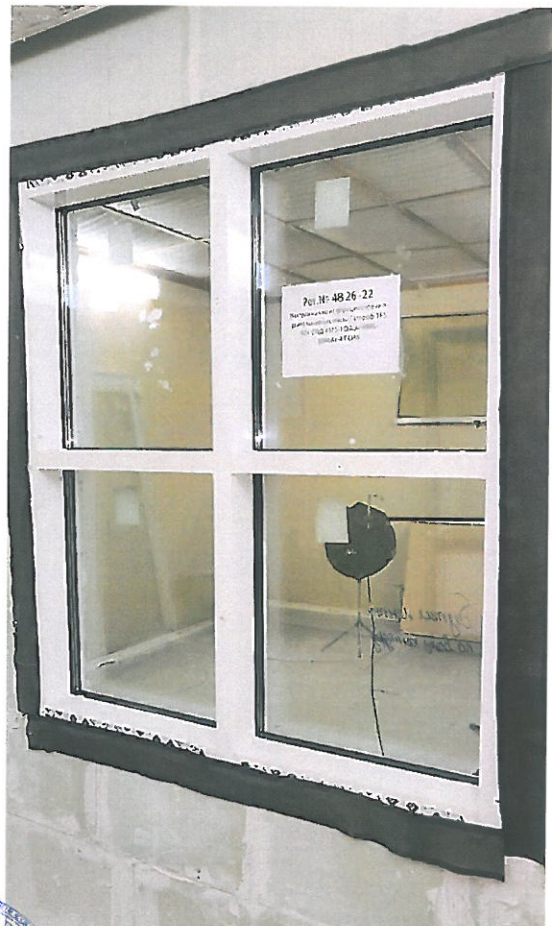
Фото 8. Камера высокого уровня, (испытание светопрозрачной конструкции рег. № 4826-22 в акустической камере)
