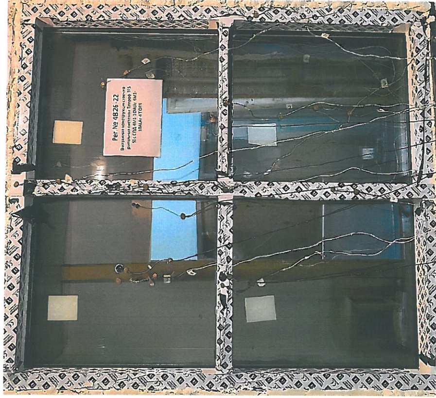
Фото 4. Светопрозрачная конструкция № 4826-22 в климатической камере (теплая сторона)
