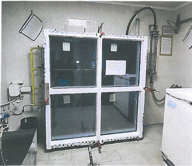
Фото 5. Испытание образца (рег. № 4826-22) на воздухопроницаемость
