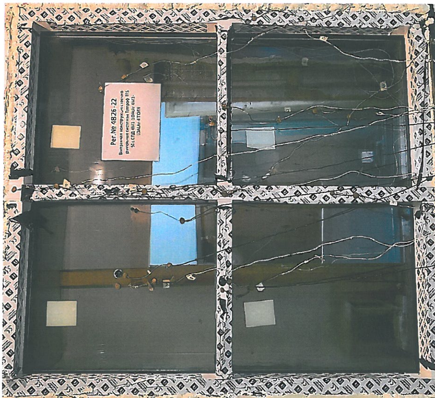
Фото 3. Светопрозрачная конструкция № 4826-22 в климатической камере (теплая сторона)
