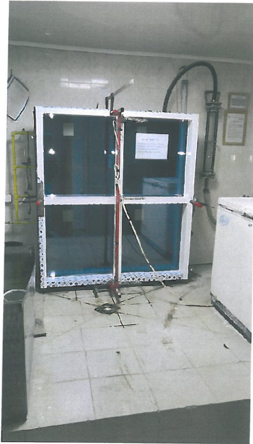
Фото 9. 10. Испытание светопрозрачной конструкции рег. № 4830-22 на сопротивление ветровым нагрузкам
