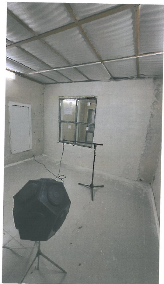
Фото 8. Камера высокого уровня, (испытание светопрозрачной конструкции рег. № 4830-22 в акустической камере)
