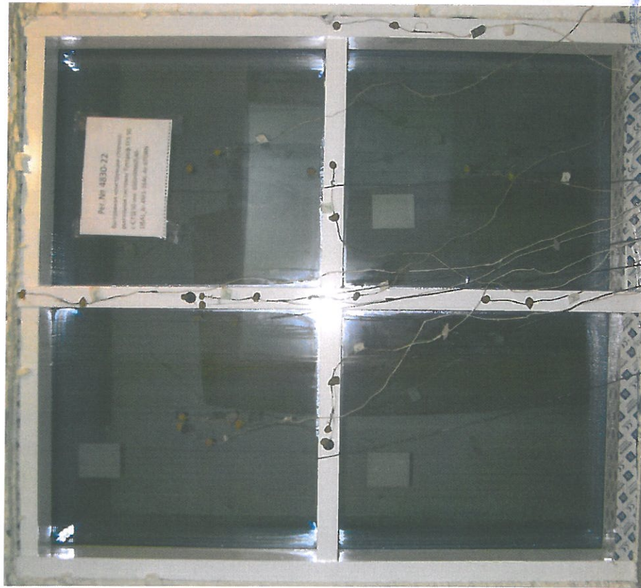
Фото 2. Светопрозрачная конструкция № 4830-22 в климатической камере (теплая сторона)
