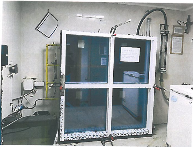
Фото 5. Испытание образца (рег. № 4830-22) на воздухопроницаемость
