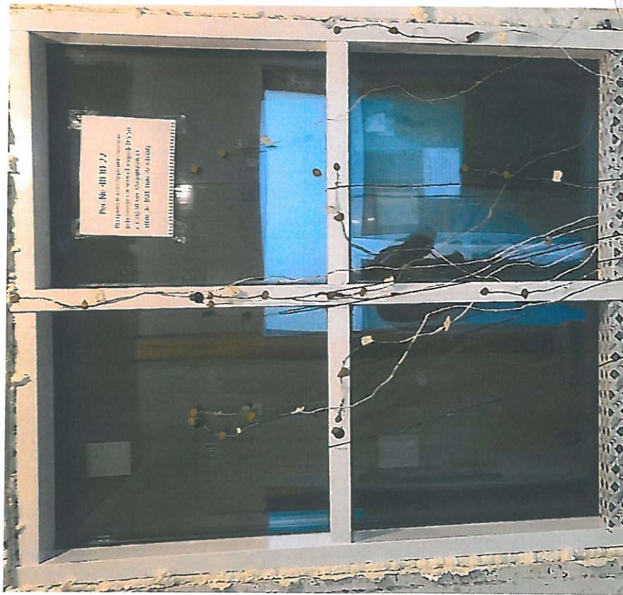
Фото 1. Светопрозрачная конструкция № 4830-22 в климатической камере (теплая сторона)
