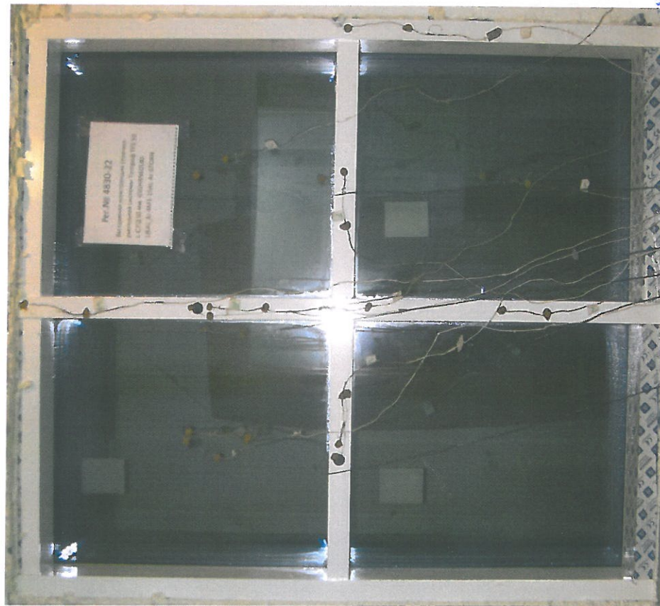
Фото 3. Светопрозрачная конструкция № 4830-22 в климатической камере (теплая сторона)
