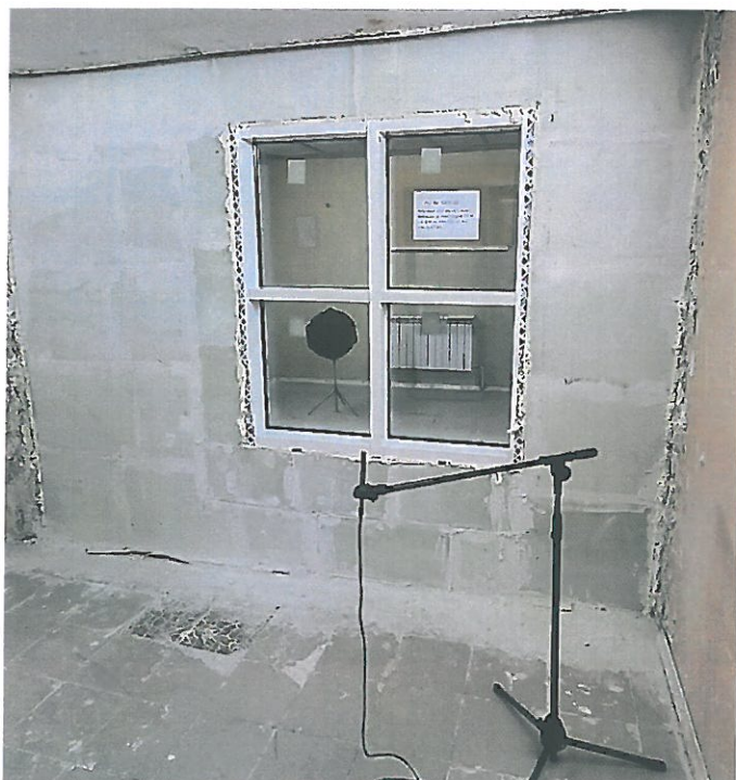
Фото 7. Камера низкого уровня, (испытание светопрозрачной конструкции рег. № 4831-22 в акустической камере)
