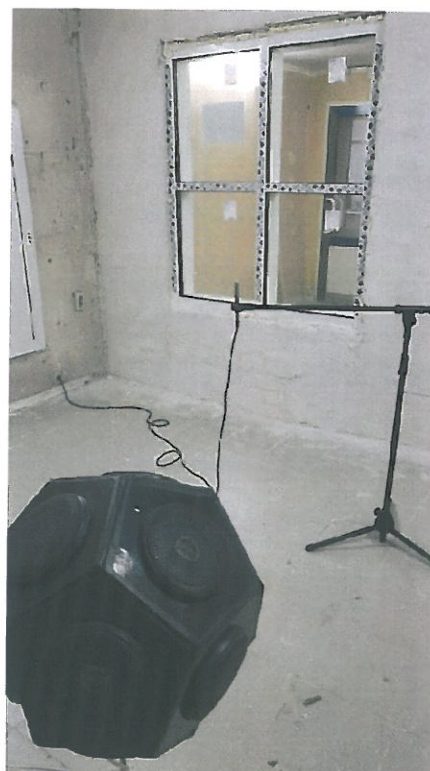
Фото 8. Камера высокого уровня, (испытание светопрозрачной конструкции рег. № 4831-22 в акустической камере)
