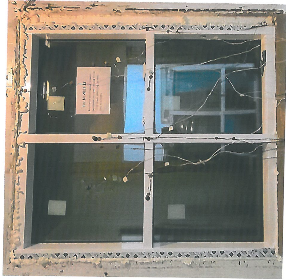
Фото 2. Светопрозрачная конструкция № 4831-22 в климатической камере (теплая сторона)
