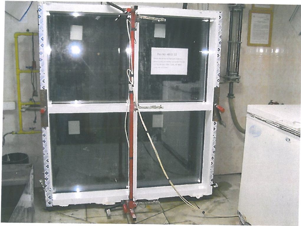
Фото 9. Испытание светопрозрачной конструкции рег. № 4831-22 на сопротивление ветровым нагрузкам
