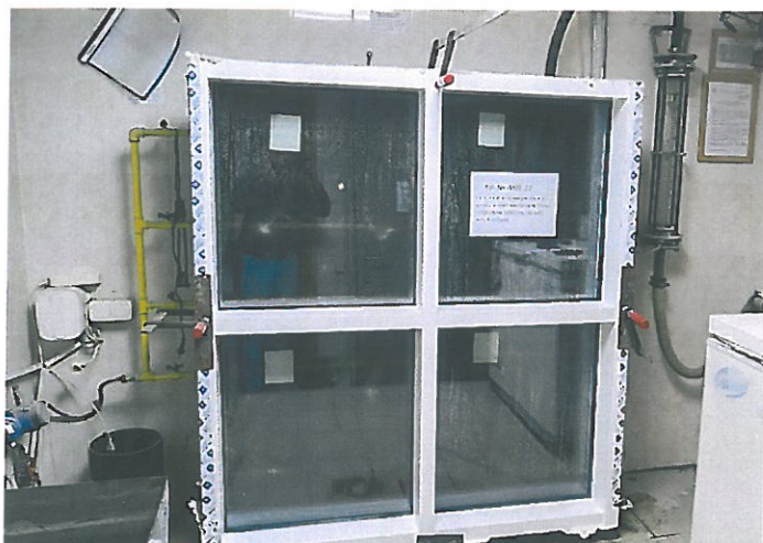
Фото 5. Испытание образца (рег. № 4831-22) на воздухопроницаемость
