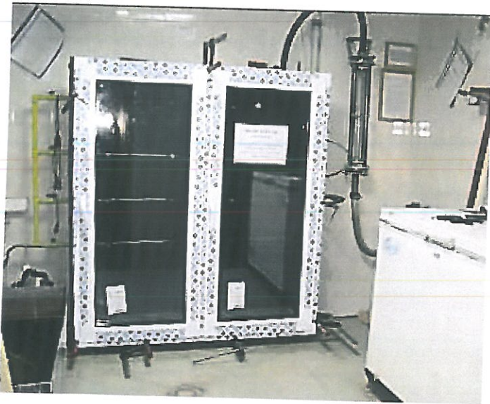
Фото 2. Испытание образца (рег. № 4741-22) на воздухопроницаемость
