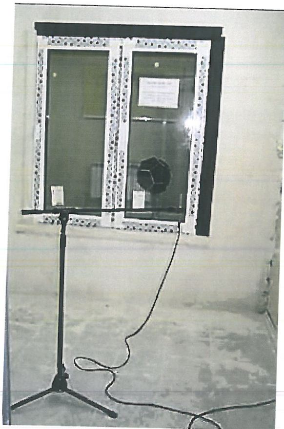
Фото 4. Камера низкого уровня, (испытание оконного блока рег. № 4741-22 в акустической камере)
